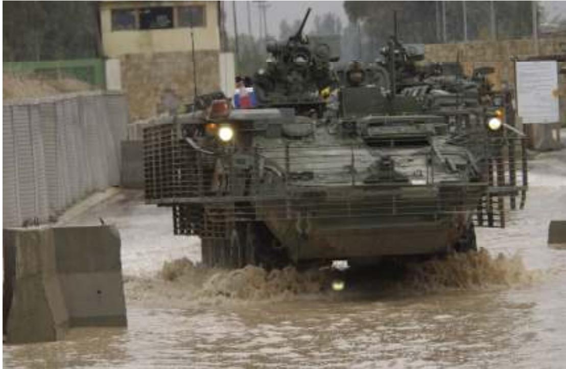
En amerikansk Stryker med det norskproduserte våpentårnet Inspector RWS patruljerer de oversvømte gatene i Mosul i Irak. Våpentårnet blir produsert av Kongsberg Defence System.
